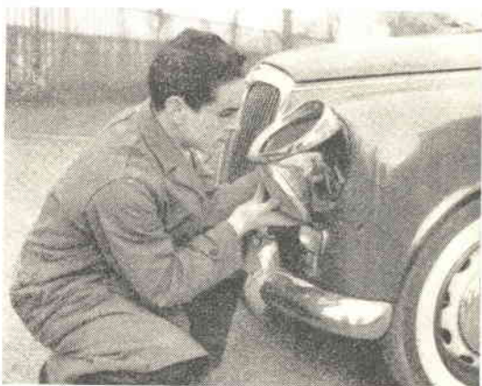
Fig. 7 - Provveduto che si sia alla sostituzione, sistemeremo la cornice e controlleremo l'allineamento.
