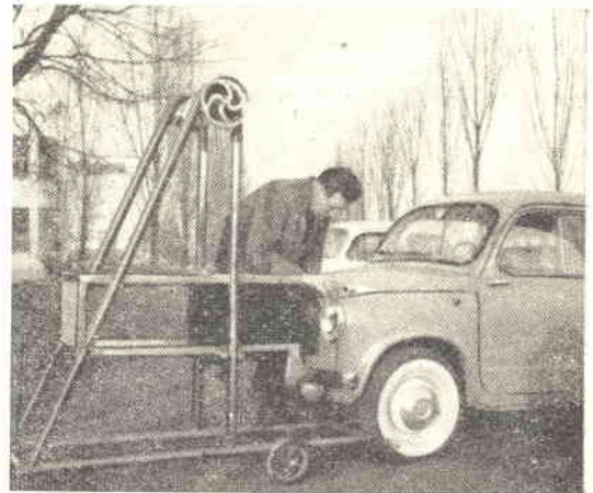
Fig. 17 - Di somma importanza ai fini di un ottimo rendimento dell'asimetrico risulta l'esatto orientamento a montaggio effettuato, per la qual cosa è consigliabile l'uso del Regloscope in dotazione agli elettrauto.
