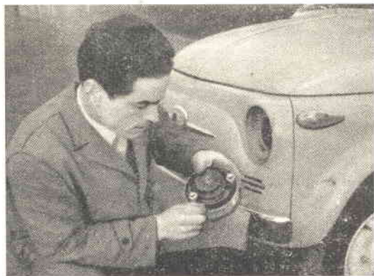
Fig. 3 - Si sostituisca al preesistente il gruppo ottico asimmetrico fornito dalla S. p. A. CARRELLO...
