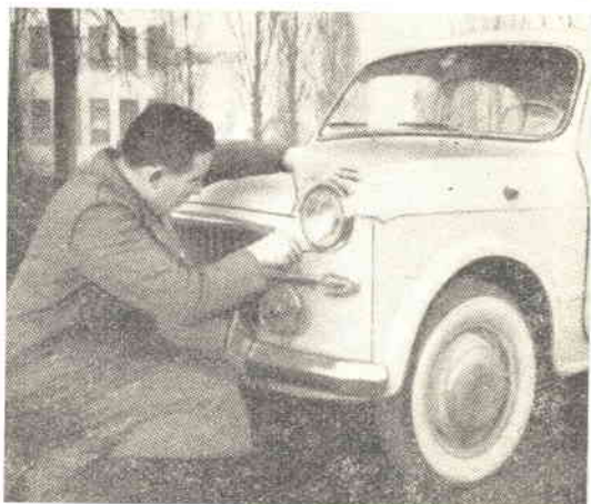
Fig. 7 - Provveduto che si sia alla sostituzione, sistemeremo la cornice e controlleremo l'allineamento.
