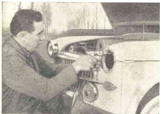
Punzonati i centri di foratura mediante impiego della mascherina di riferimento effettueremo le forature...
