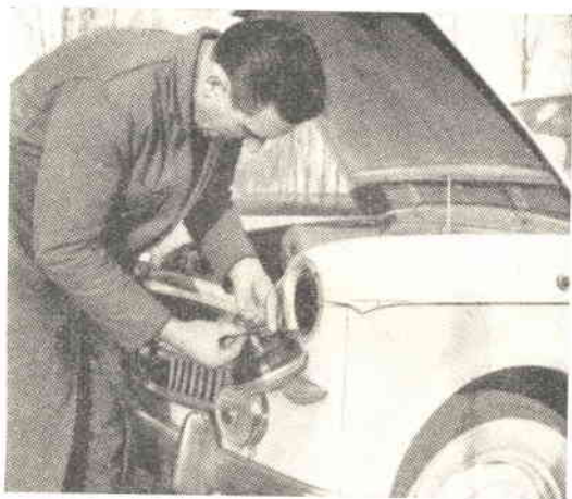
Fig. 6 - Smontato il preesistente, sostituiamo a detto il proiettore asimmetrico curandone gli allacciamenti...
