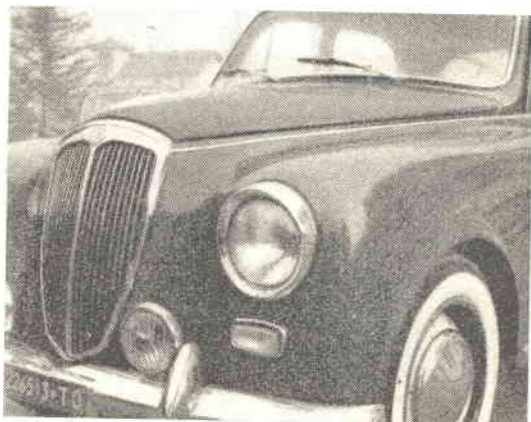
Fig. 8-9 - Sostituzione del proiettore normale con altro tipo asimmetrico su vettura Lancia.
