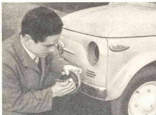
Fig. 2 - Sulla FIAT 500 le operazioni di sostituzione del gruppo ottico si presentano particolarmente semplici. Si smonti il faro e si tolga il gruppo ottico...
