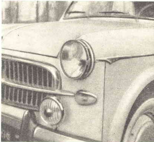
Fig. 14 - Fisseremo il proiettore alla carrozzeria, procedendo all'allineamento perfetto.
