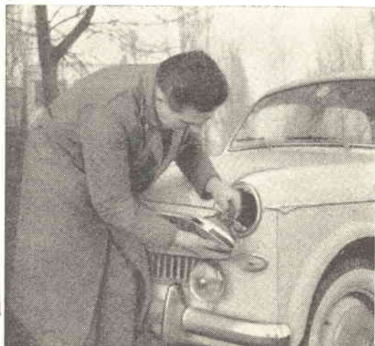
Fig. 13 - Collegheremo i conduttori alla lampada del proiettore...
