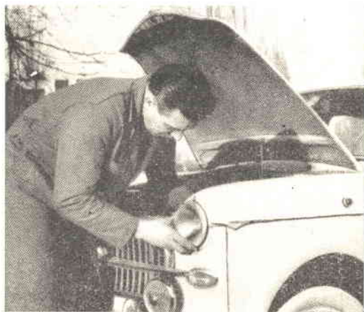
Fig. 5 - Pure per la sostituzione del proiettore asimmetrico completo per le 1.100 le operazioni sono quanto mai semplici...
